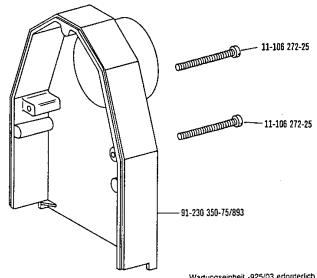
Blasvorrichtung Blower Dispositif à jet d'air Wartungseinheit -925/03 erforderlich Conditioning unit -925/03 required
